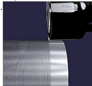
Il processo avviene quindi per deformazione plastica a freddo, senza asportazione di trucioli di materiale, permettendo di ottenere delle superfici estremamente lisce, con una finitura pari o maggiore a quella raggiungibile grazie al processo di rettifica.
